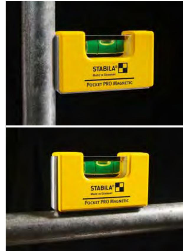
**Pocket PRO Magnetic:** nivel de burbuja profesional en formato de bolsillo, Robusta carcasa con núcleo de aluminio rectangular y dos superficies de medición fresadas con precisión y con ranura en V para mediciones horizontales y verticales. Potentes imanes de neodimio raras en las bases de medición inferior y lateral. Especialmente adecuado para trabajos en la industria metálica. Herramienta de medición auxiliar para profesionales.
