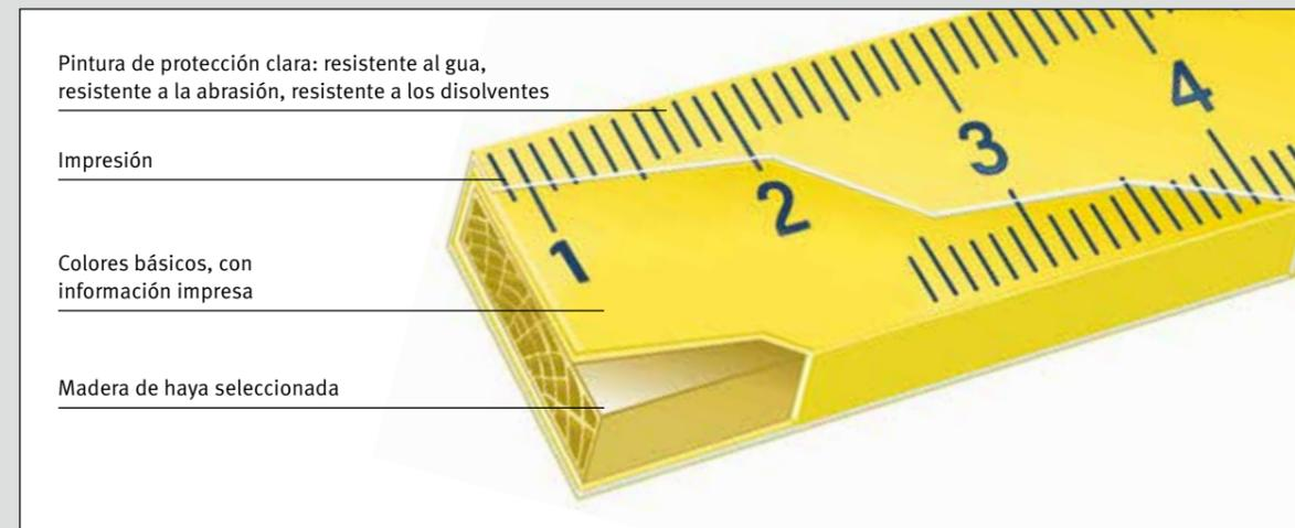
Pintura de protección clara: resistente al agua, resistente a la abrasión, resistente a los disolventes
