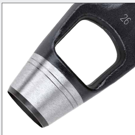
cabezal de corte cónico, pulido y pelado, por dentro ligeramente cónico para retirar los recortes
