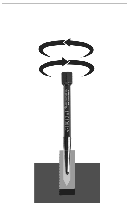
Alojar y desenroscar el tornillo atascado con una herramienta adecuada
