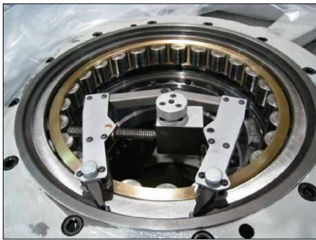
Una herramienta para anillos interiores y exteriores
